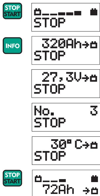
1. Ladevorgang durch Drücken der Start/Stop-Taste unterbrechen.
