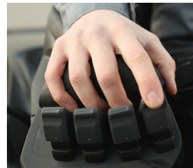
Vingertipbedieningen hydraulica (optioneel)
