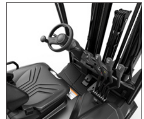
Hendel voor handmatige bediening hydraulisch systeem
