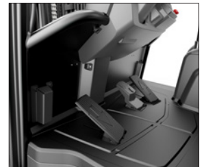
Systeem met twee pedalen - vooruit en achteruit
